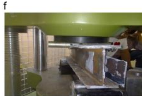
f web debonding
