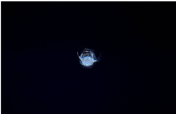
Impacto en la cúpula de cristal de la Estación Espacial Internacional el pasado día 12. Es de 7 centímetros. /ESA
