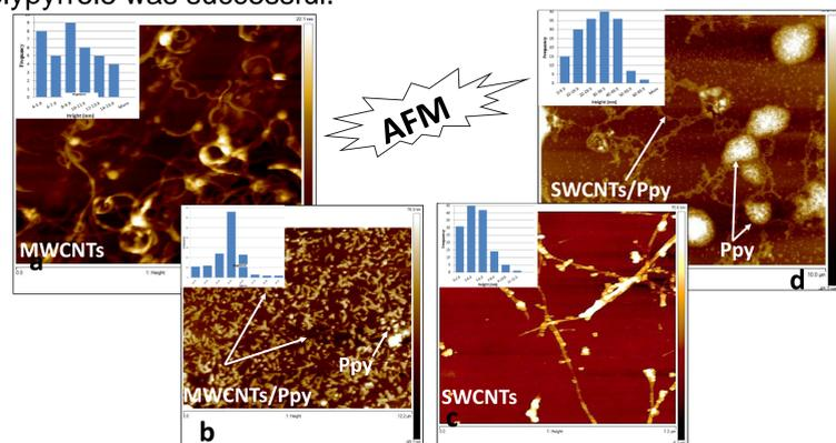
AFM height images of (a) MWCNTs, (b) MWCNT/Ppy composite, (c) SWCNTs, (d) SWCNT/Ppy composite.
